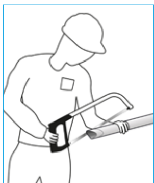
11 - Ajuster le dernier tronçon en sciant l'excédent rétreint.
