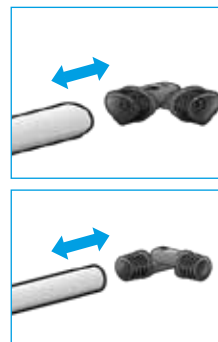
9 - Insérer les angles des lisses et des sous-lisses.
